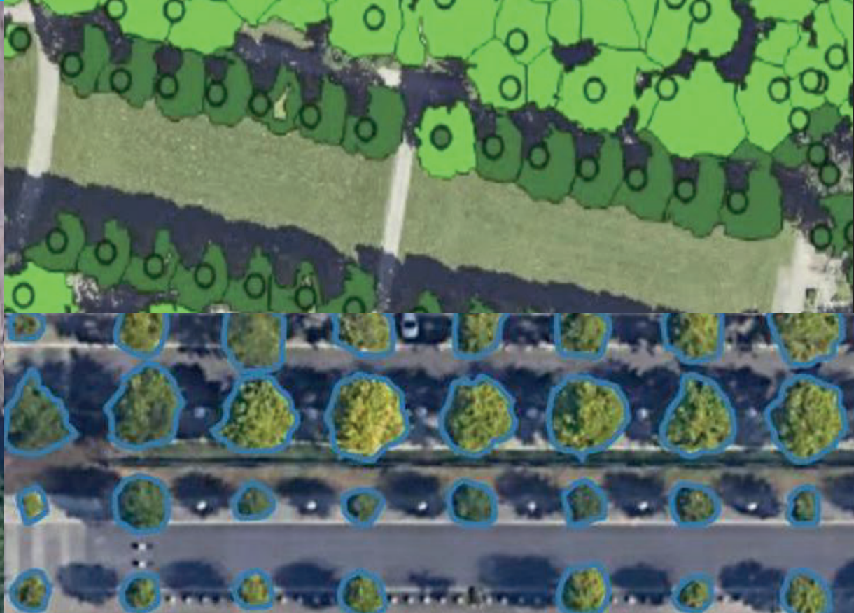
Baumerkennung: Mitbewerber (oben) im Vergleich zu ForSens (unten)
