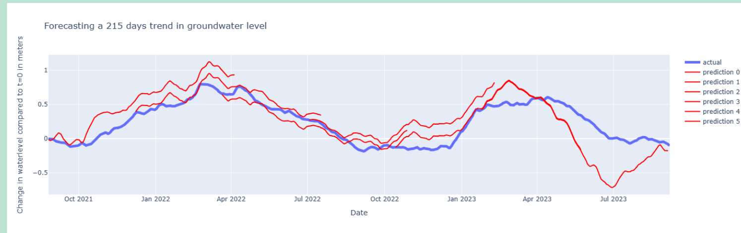
Erste Ergebnisse des Frühwarnsystems zur Vorhersage von Wasserständen in Trinkwasserbrunnen.
